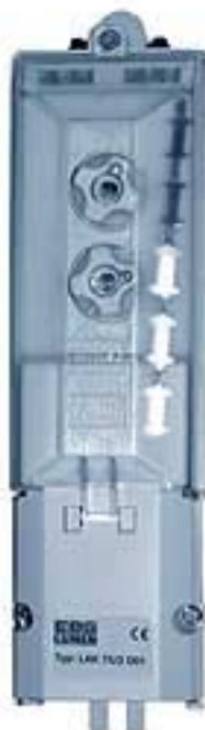
Tabliczka LAK L - tabliczka LAK 75 LAK1 - TA17 - 6005 LAK2 - TA17 - 6006 II klasa izolacji, IP 44 Możliwość przyłączenia dwóch kabli do 5x25mm Gniazdo bezpiecznikowe 1-2 E14
