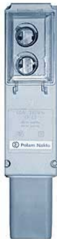
Tabliczka TZK N - tabliczka NAKŁO TZKO - TA15-2002 II klasa izolacji, IP 43 Możliwość przyłączenia dwóch kabli do 4x35 mm Gniazdo bezpiecznikowe 1-2 E27
